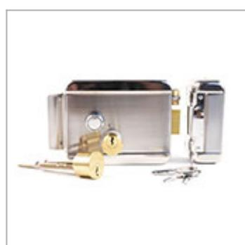
**Электромеханический замок Anxing Lock - AX042** изготовлен в корпусе из нержавеющей стали и может постоянно эксплуатироваться в уличных условиях. Открыть замок можно дистанционно кнопкой на экране домофона, кнопкой выхода на корпусе замка или механическим ключом (3 шт. в комплекте).
